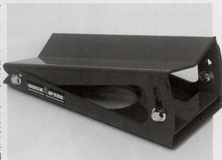
本文中に“らくらく君”と書いたが、正式には“タイヤらくらく君”といい、本体には“クイックリフター”というネームプレートが貼られる。厚手の鉄板を使った作りは非常に強固で、重量級のホイールを載せてもビクともしない。裏の足の滑り具合も過不足なく、つま先を軽く押せば、狙いの位置に差し込める。ただし、ストッパーは装備していないので、使用中、つま先を添える必要がある。とはいえ、つま先を差し込むよりは、うんと快適に作業できる。価格は6090円だ
