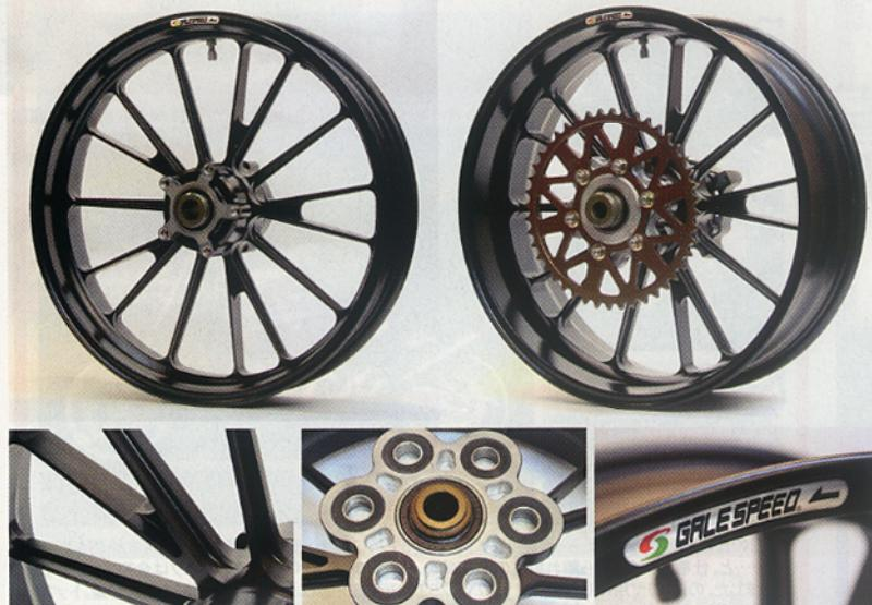
昨年秋から発売が始まったゲイルスピード・タイプSは、独自の切削加工技術によって既存のタイプSやR以上の軽量・高剛性化を実現した。アクティブにとっては最新のアルミ鍛造ホイール。対応機種は'90年代以降のビッグバイクがメインだが、前後12インチのミニバイク用も存在。DAEG用は
