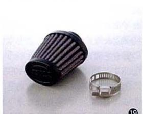
①エアクリーナーの装着に際して私が心配したのは、2007年10月号で報告したドライスタートを防止するための装置であるジップスタート（書くと長くなるのではあるが、エンジンを始動する前にメタル類にオイルを圧送して摩耗を防ぐという、まさに素晴らしいメカニズム。ZIP-STARTで検索すればすぐ見つかる）をキャブレターの後方に取り付けていたことと、クランクケース内を減圧するエラーパルプがそんなには小さくないという2点であった。しかし、この写真でわかるように、すべてが計画されていたかのように、どんびしゃりと収まっている（エラーパルプは見えない。2番気筒用FCRのトップキャップ上に見える白いものは燃料フィルター）。②エアクリーナーはDNAのOV-5400（1個5250円）、樹脂製のアダプターはK&N製のFCR φ35~41mm用タイプ2（丸）φ55mm（1個1312円）。4気筒だから全部で2万6248円。安くはないが出来はすごく良い。③アダプターはスローモードもっかりカバーする設計。ただし、スローモードを調整するときには外す必要あり。④エアファンネルをすべて外し、1番気筒のFCRに
